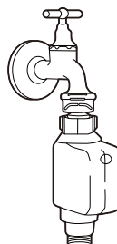
tuyau d'arrivée d'eau de sécurité
