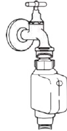
manguera de entrada de agua de seguridad
