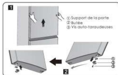
4. Retirez la porte supérieure et placez-la sur une surface plate, panneau vers le haut. Desserrez les vis(3), détachez les pièces(1) et(2) puis installez la pièce(1) et l'autre pièce(2) (dans le sac plastique) du côté gauche avec les vis(3). Replacez la pièce(2) que vous venez de détacher dans le sac plastique.
