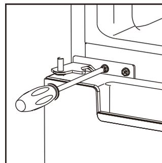
8. Remettez la porte supérieure en place. Assurez-vous que la porte est alignée horizontalement et verticalement afin que le joint soit fermé de tous les côtés avant de finalement serrer la charnière supérieure. Insérez ensuite la charnière supérieure et vissez-la en haut de l'unité, puis fixez le couvercle de la charnière (dans le sac d'accessoires) à l'aide de vis.
