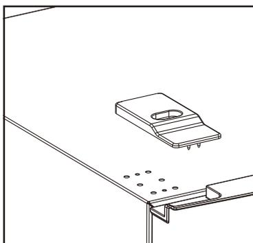
3. Retirez la porte supérieure, retirez la vis de la charnière centrale à l'aide d'un tournevis cruciforme, puis retirez la porte inférieure.
