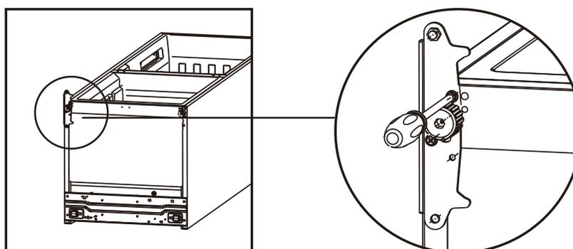
7. Installez la porte inférieure, ajustez et fixez la charnière centrale sur l'armoire.
