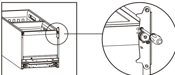
5. Réglage de la position centrale de la charnière de la charnière inférieure et de la charnière supérieure en position opposée
