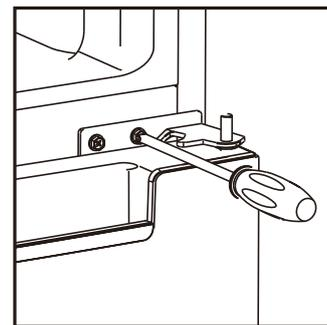
4. Coucher le réfrigérateur, retirer les pieds de réglage comme ci-dessous, puis retirer la charnière inférieure à l'aide d'un tournevis cruciforme.
