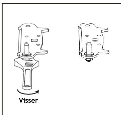
11. Réinstallez le support de montage de la goupille de la charnière inférieure. Remettez les deux pieds réglables.
