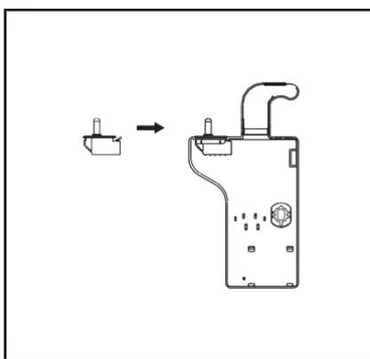
5. Détachez le cache sur la porte supérieure et déplacez le faisceau de câblage du côté droit vers le côté gauche, puis remettez le cache.
