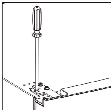
16. Branchez les faisceaux de câblage de la porte et du meuble. Puis remettez le cache de la charnière supérieure. Avant de visser le cache, raccordez les bornes du contacteur de porte.
