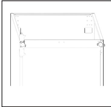
12. Retirez les ferme-porte de la partie inférieure de la porte supérieure et de la porte inférieure, puis prenez les nouveaux ferme-porte dans le sachet d'accessoires et installez-les sur le côté gauche.
