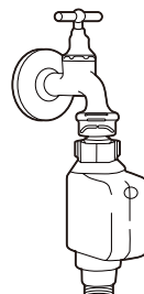
tuyau d'arrivée d'eau de sécurité
