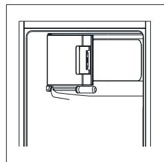
8. Schroef het onderste scharnier los. Verwijder vervolgens de stelvoeten aan beide zijden.
