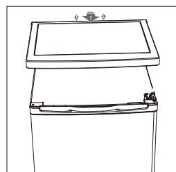
3. Schrauben Sie das obere Scharnier ab, entfernen Sie die Tür und legen Sie sie auf eine weiche Unterlage, um Kratzer zu vermeiden.
