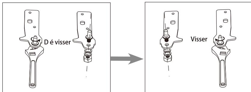
10. Remontez le support en installant l'axe de charnière inférieur. Remplacez les deux pieds réglables.
