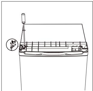
12. Setzen Sie die obere Abdeckung auf und befestigen Sie sie mit 2 Schrauben auf der Rückseite.
