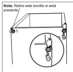
9. Desatornille y retire el pasador de la bisagra inferior, dé vuelta el soporte y reemplácelo.
