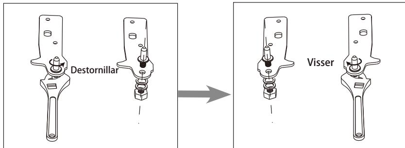
10. Vuelva a colocar el soporte que encaja en el pasador de la bisagra inferior. Reemplace ambos pies ajustables.
