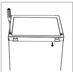
13. Lösen Sie die Türdichtungen des Kühlschranks und des Gefrierschranks und bringen Sie sie nach dem Drehen wieder an.
