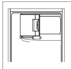
8. Unteres Scharnier abschrauben. Entfernen Sie dann die verstellbaren Füße auf beiden Seiten.
