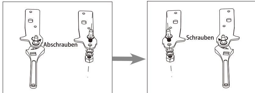
10. Bringen Sie die Halterung wieder an, die zum unteren Scharnierstift passt. Ersetzen Sie beide verstellbaren Füße.
