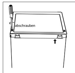
2. Entfernen Sie die obere Abdeckung und legen Sie sie beiseite.
