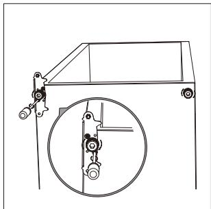
11. Placez la porte. Assurez-vous que la porte est alignée horizontalement et verticalement, de sorte que les joints soient fermés de tous les côtés avant de finalement serrer la charnière supérieure.
