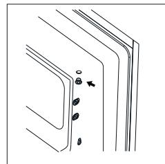
7. Draai de deur van de vriezer en plaats de scharnierzijde aan de linkerkant. En de fix de deur door houder.
