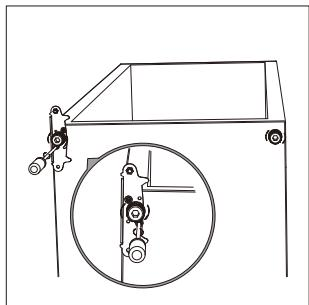
11. Bringen Sie die Tür wieder an. Stellen Sie sicher, dass die Tür horizontal und vertikal ausgerichtet ist, damit die Dichtungen allseitig geschlossen sind, bevor Sie das obere Scharnier endgültig festziehen.
