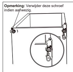
9. Draai de onderste scharnierpen los en verwijder deze, draai de beugel om en plaats hem terug.
