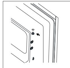
7. Drehen Sie die Tür des Gefrierschranks und legen Sie die Scharnierseite auf die linke Seite. Und die Tür durch Halter fixieren.
