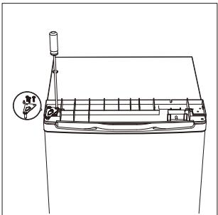
12. Coloque la cubierta superior y fíjela con 2 tornillos en la parte posterior.
