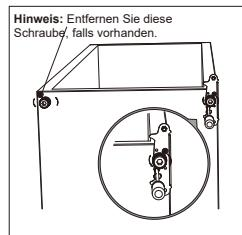
9. Lösen und entfernen Sie den unteren Scharnierstift, drehen Sie die Halterung um und ersetzen Sie sie.
