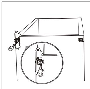
11. Plaats de deur er weer op. Zorg ervoor dat de deur horizontaal en verticaal is uitgelijnd, zodat de afdichtingen aan alle kanten gesloten zijn voordat u het bovenste scharnier definitief vastdraait.
