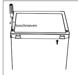
2. Verwijder de bovenklep en leg deze opzij.
