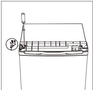
12. Mettez le capot supérieur et fixez-le avec 2 vis à l'arrière.
