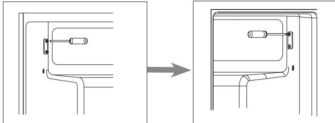
6. Mueva la cubierta del orificio de la bisagra del lado izquierdo al lado derecho.
