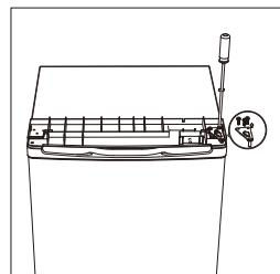
4. Schrauben Sie das untere Scharnier der Gefrierfachtür ab. Entfernen Sie dann die Tür und legen Sie sie auf eine weiche Unterlage, um Kratzer zu vermeiden.
