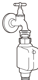
tuyau d'arrivée d'eau de sécurité
