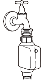
manguera de entrada de agua de seguridad
