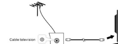
Il est recommandé d'utiliser un câble antenne de 75Ω afin d'éliminer tout risque de bruit et d'interférences.
