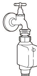
tuyau d'arrivée d'eau de sécurité
