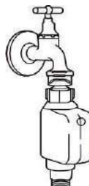
manguera de entrada agua de seguridad
