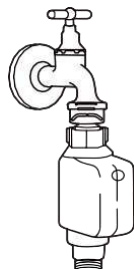
tuyau d'arrivée d'eau de sécurité
