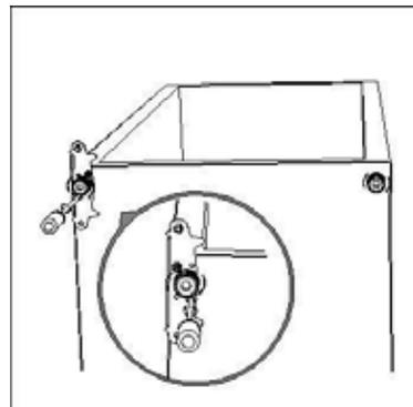
11. Remettez la porte en place. Assurez-vous que la porte est alignée horizontalement et verticalement, afin que les joints soient fermés de tous les côtés avant de serrer enfin la charnière supérieure.
