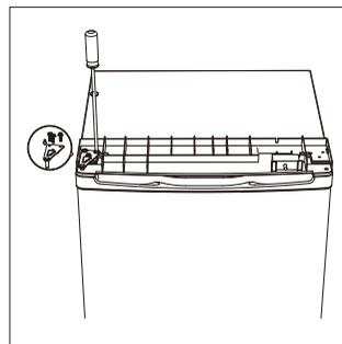
8. Mettez le capot supérieur et fixez-le avec 2 vis à l'arrière.
