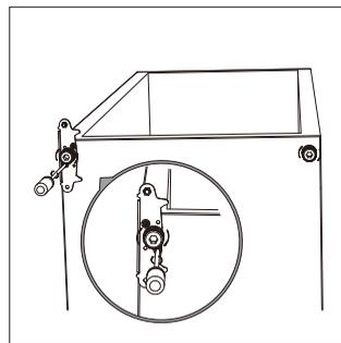
7. Remettez la porte en place. Assurez-vous que la porte est alignée horizontalement et verticalement, afin que les joints soient fermés de tous les côtés avant de serrer enfin la charnière supérieure.
