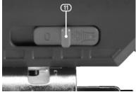
Lorsque l'outil est utilisé avec une aspiration connectée, activer l'extraction, au moyen de l'interrupteur (1) qui doit être en position avancée. Ainsi un canal s'ouvre, de sorte que l'air extrait puisse être évacué de la zone de la lame en gardant les lignes de coupe marquées visibles.
