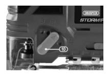
Tourner l'interrupteur de réglage orbital (10) pour activer le réglage requis.
