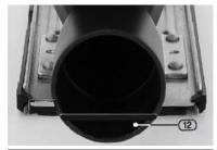
La sortie d'extraction des poussières (12) doit être reliée à une machine d'extraction des poussières.
