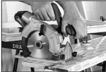
Tenir la scie fermement au moyen des deux poignées (arrière + auxiliaire).
