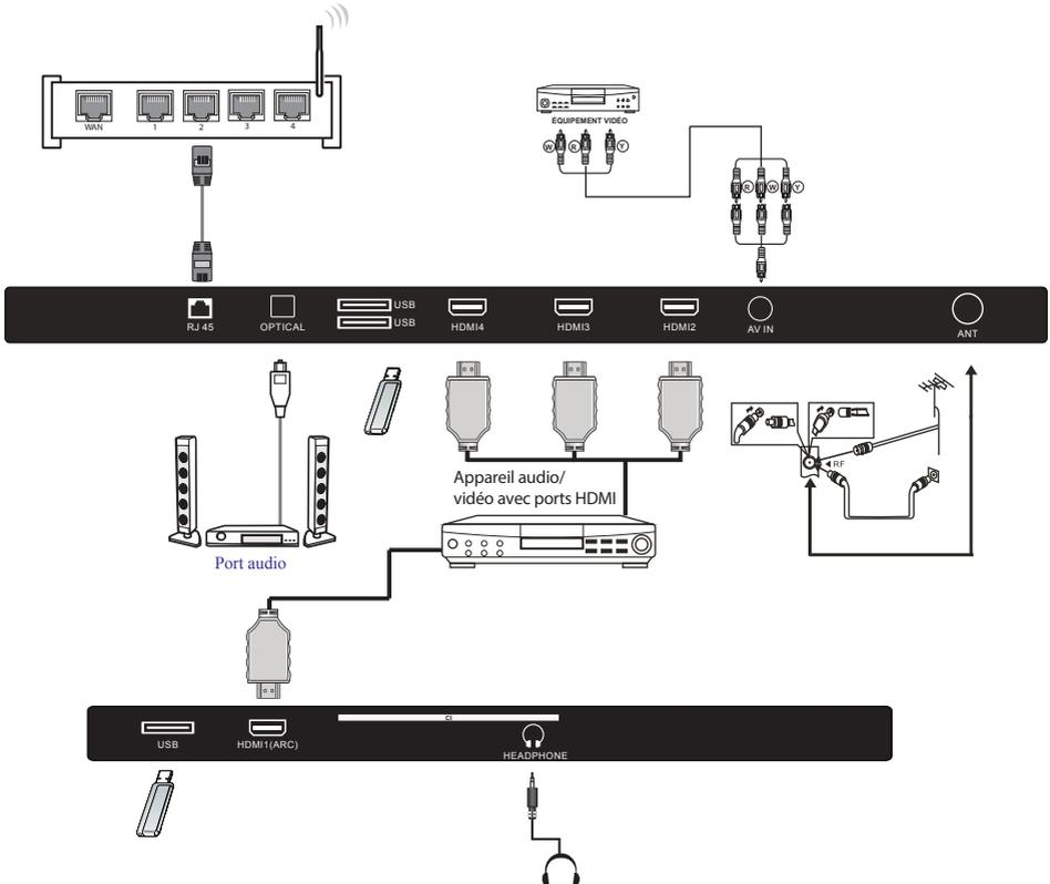
Peut être connecté aux appareils suivants : Magnétoscope, lecteur multidisque, lecteur DVD, caméscope, console de jeux ou stéréo, etc.
