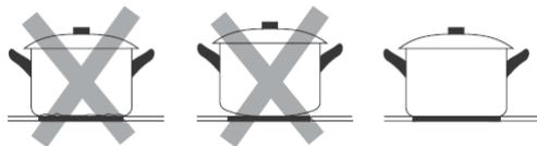
La base de l'ustensile doit être lisse, reposer à plat sur le verre et être de même taille que la plaque. Placez toujours l'ustensile bien au centre de la plaque.
