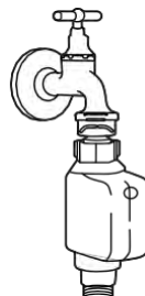
tuyau d'arrivée d'eau de sécurité
