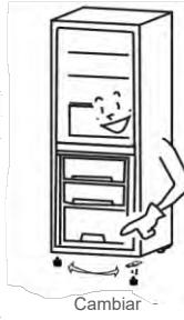
5. Retire el pasador de la bisagra en la parte inferior de las puertas del compartimiento del refrigerador y del congelador. Inserte el pasador de bisagra de repuesto que vino con la unidad en el otro lado de la puerta.
