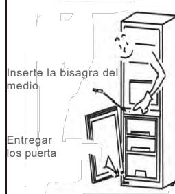
7. Coloque la puerta del compartimiento del congelador en la bisagra del medio, asegurándose de que el pasador de la bisagra esté insertado en el orificio en la parte inferior de la puerta del refrigerador. Vuelva a colocar la cubierta superior de adelante hacia atrás, luego atornille los dos pernos en la parte posterior de la cubierta superior.
